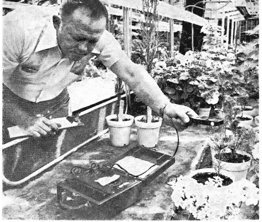
Elektrik mühendisliği teknisyeni Stanley P. Holliday, bitkilerin üzerine düşen gerek direkt gerekse çevre ışığını ölçmek için bir ayak mumu ölçeğini kullanıyor.
