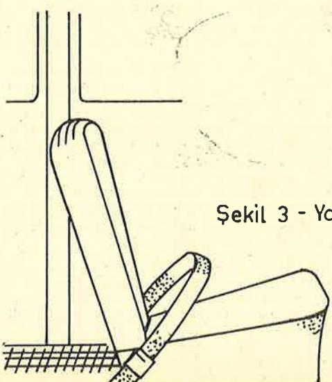
Şekil 3 - Yatay karın altı kemeri
