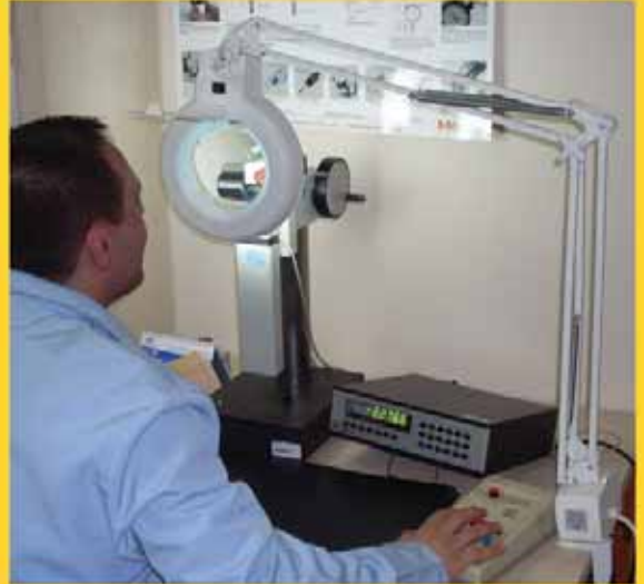
Boyutsal Kalibrasyon Cihazı (Ölçü Saati Kalibratörü)
