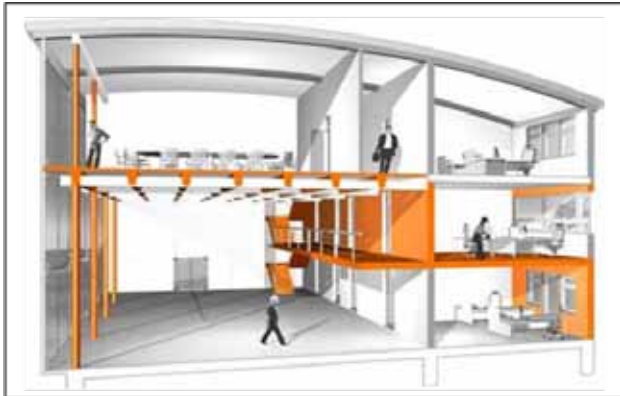
Şekil 4: Prefabrik karma sistem uygulaması, İskelet + Panel sistem [14]
