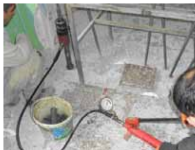
Resim 4, 5, 6. Demir çubuk ekimi yapıldıktan sonra demir çubuklara ankraj çekme testi uygulanmıştır.
