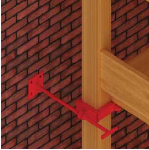
Şekil 3. Cephne bağlantı elemanı ve uygulaması
